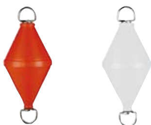
Gavitello da ormeggio in polietilene soffiato con asta passante e girella in acciaio inox, riempito di poliuretano a cellule chiuse.
