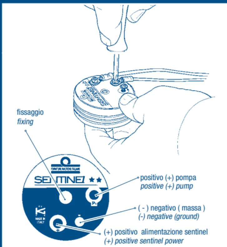
Applicare i capicorda sui cavi, fissarli mediante le viti in dotazione seguendo le indicazioni illustrate e la tabella di seguito. Attenzione a non esagerare con la forza di serraggio.
