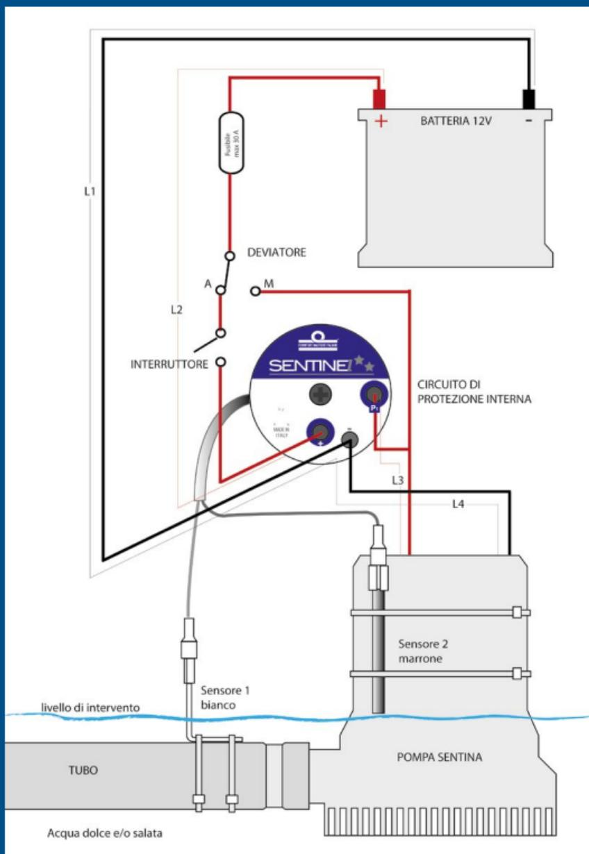
Il miglior funzionamento lo si ottiene posizionando i sensori allo stesso livello. Per questa installazione, però è molto difficoltoso creare il fissaggio del sensore 1.
